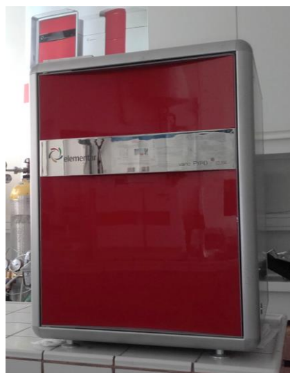
Figure 54 : Dispositif analytique pour la mesure du \delta^{18}\text{O} de la bioaptite des vertébrés marins actuels et fossiles avec, à droite , l'analyseur élémentaire varioPYROcube™, et à gauche , le spectromètre de masse IsoPrime™. © Nicolas Séon
