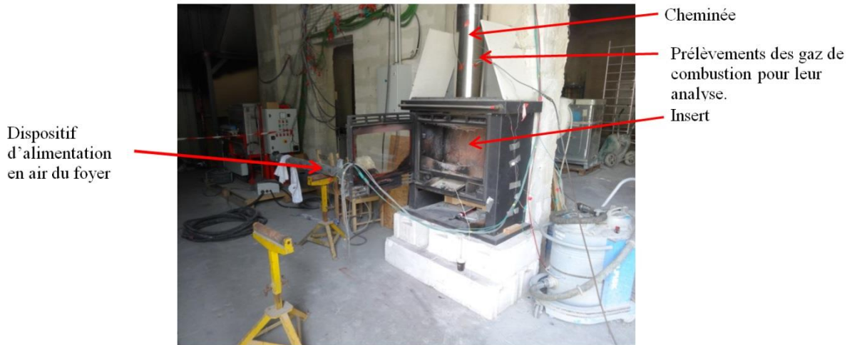
Figure II-46- Système de carbonisation expérimental installé au CSTB.
