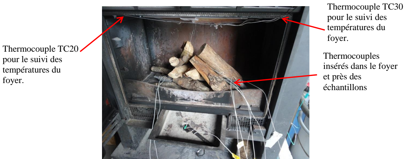
Figure II-47- Organisation interne de l'insert lors de la deuxième carbonisation.
