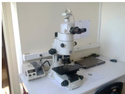
Figure II-69- Macroscopie Nikon AZ100 de la plateforme d'archéobotanique du laboratoire AASPE (MNHN).
