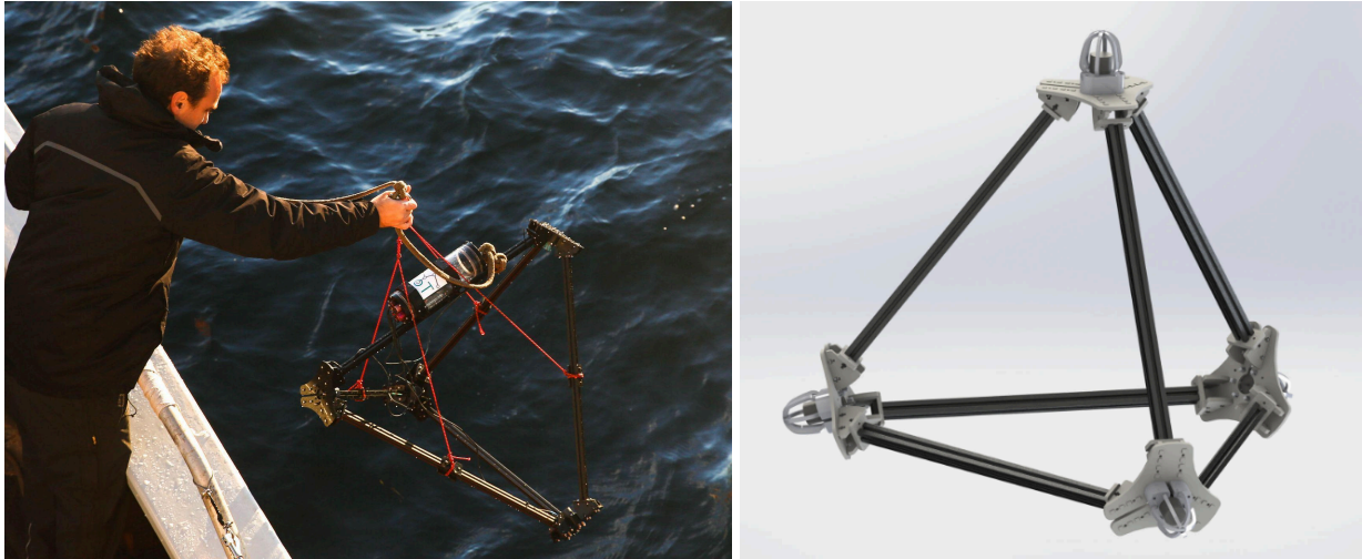
Figure 6.4 : (Gauche) Mise à l'eau depuis Isbjorn II (crédit photo Gies) de l'antenne tétraédrique, équipée de sa carte son et ses quatre hydrophones, conçue par SMIoT LIS IM2NP UTLN (Droite).
