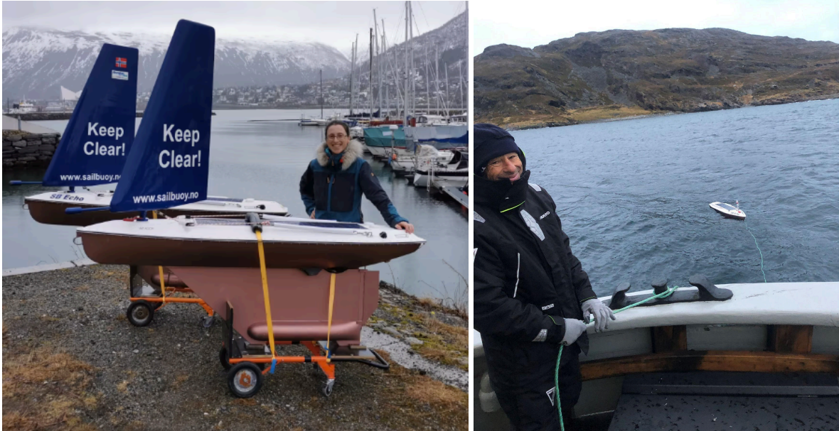
Figure 4.1 : (Gauche) le système Sailbuoy d'Akvaplan-niva permettant une mesure précise de la biomasse par son échosondeur sous coque. (Droite) la Sailbuoy déployée derrière l'Isbjorn adaptée à la dérive.
