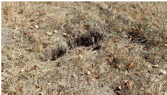
Exemple de faille de rétractation observée sur la parcelle Ouest entre deux placages de transfert suite aux conditions de sécheresse.
