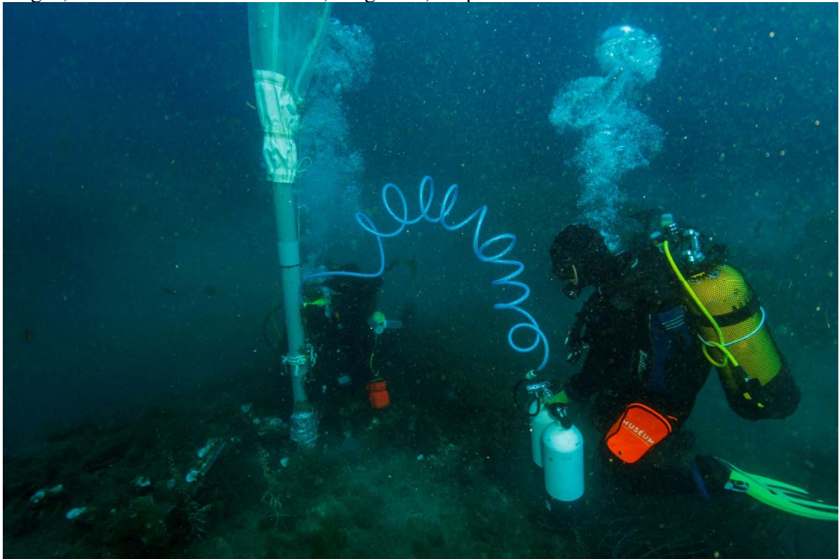
Figure 7 : Aspirateur sous-marin en plongée (source : MNHN/José Utge)
