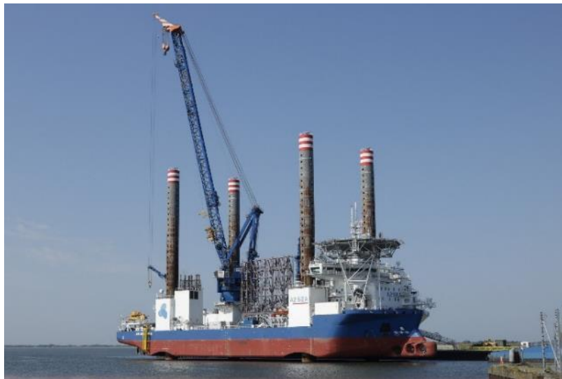
Figure 7 : navire jack-up pouvant servir à l'installation de fondations posées (photo : K. E. Vinding / Pixabay).
