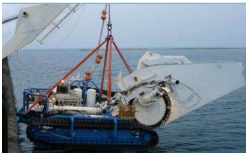
Figure 26 : Trancheuse mécanique à roue (© RTE)
