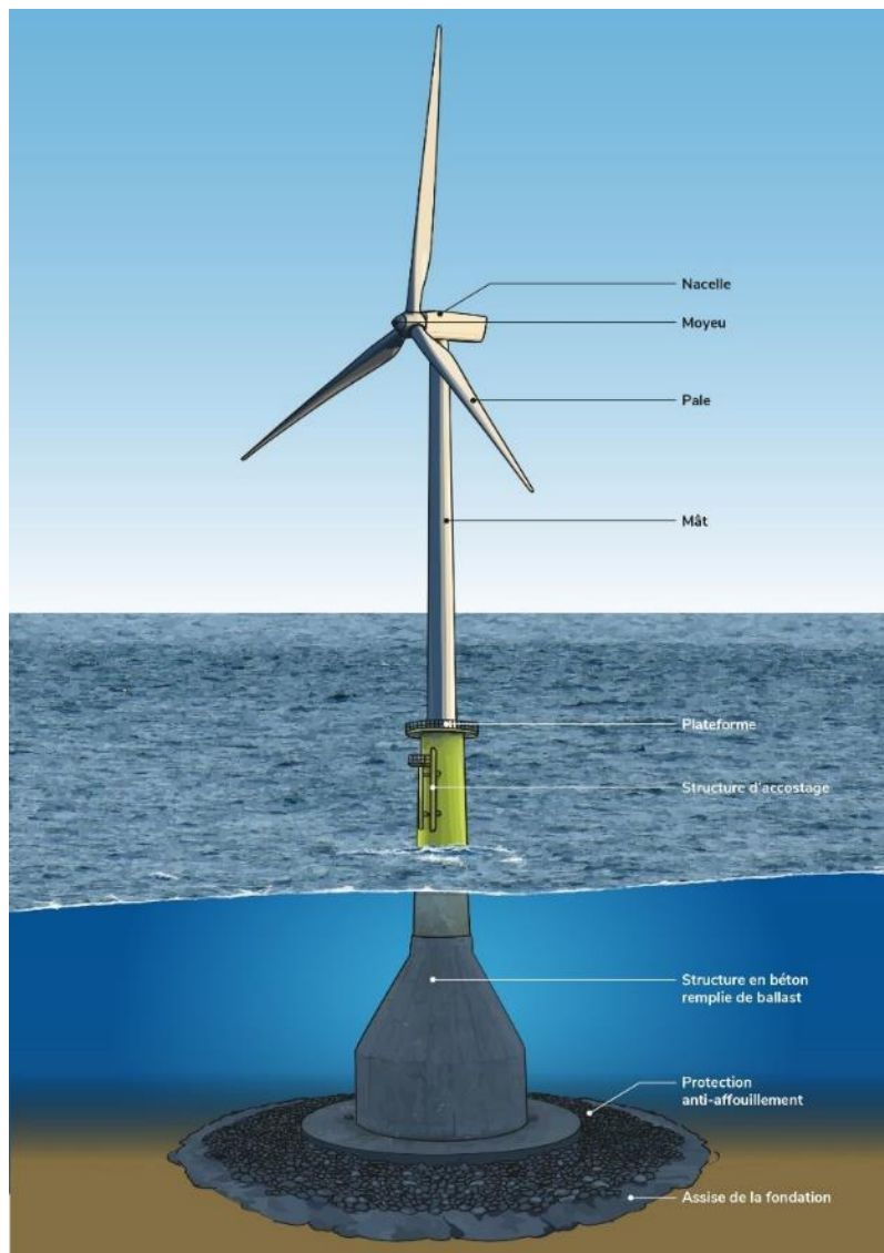
Figure 13 : schéma d'une éolienne à fondation gravitaire avec une protection anti-affouissement constituée d'enrochements (BY - Yann Souche, OFB)
