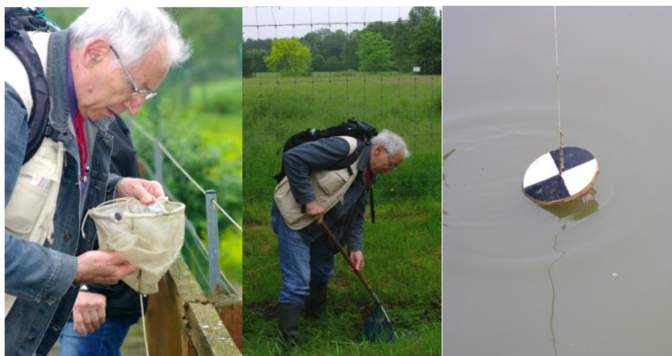
Photo 56 : gauche : observation du zooplancton dans un filet ; au milieu : recherche d'écrevisses dans un fossé en eau ; à droite : disque de Secchi.
