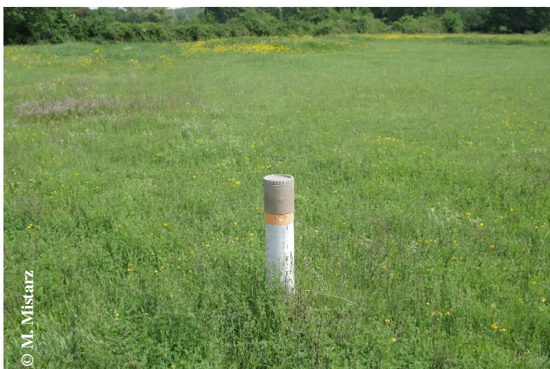
Piezomètre sur le site « Étangs et mares de la Capelle ».
