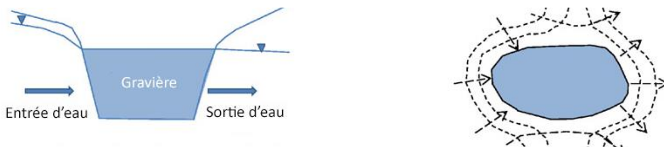
Figure 18 : Flux d'eau généralement rencontrés au sein d'une gravière dans nos régions (d'après Mollema et Antonnelleni, 2016).
