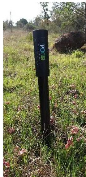
Photo 2 : Sonde « POGO Turf Pro ».
