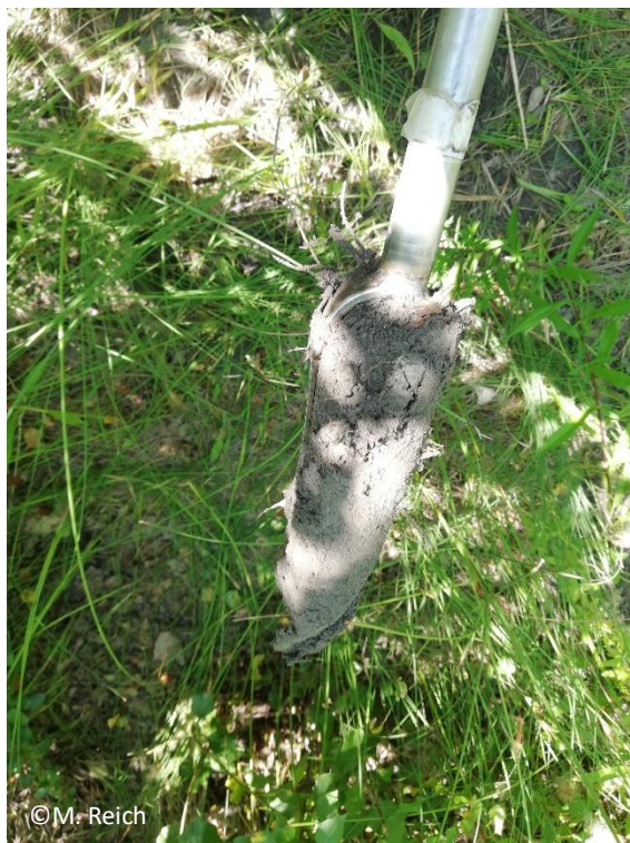
Photo 23. Sondage pédologique effectué à la tairie Edelman afin d'évaluer la nature du substrat sous les formations à petite massette.
