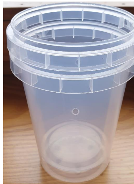
Avant d'être enterrés, les pots seront ainsi placés de cette manière : pot N°1 dans le pot N°2 (ce dispositif permet d'évacuer un éventuel trop plein d'eau en limitant la perte simultanée d'individus)
