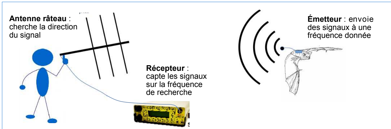
Figure 8 : principe du radiopistage.
