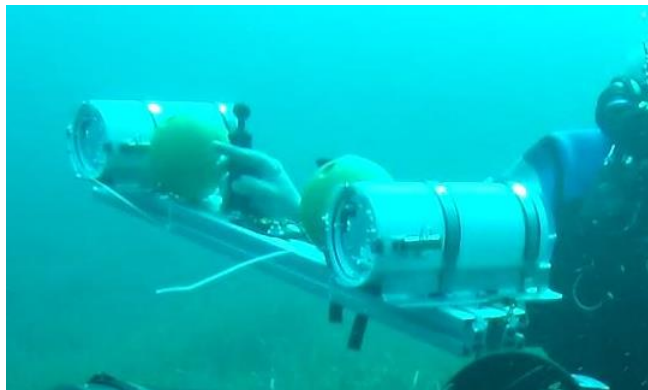
Figure 16. Photographie du cube de calibration SeaGIS utilisé pour calibrer le système stéréoscopique (a) et système stéréoscopique testé dans le Parc National des Calanques de Marseille en août 2020 équipé de deux caméras GoPros Héro 6 dans des caissons et de deux bouées oranges pour la stabilisation sous l'eau (b).
