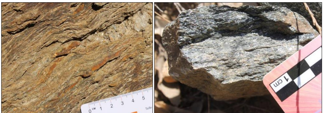
Figure 24 : A gauche, exemple de micaschiste, roche métamorphique. A droite, exemple d'amphibolite, roche métamorphique ©GE/EA.
