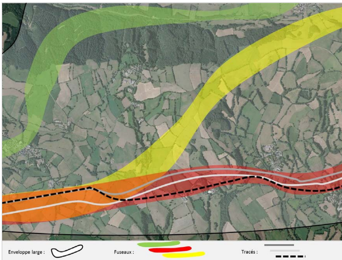
Figure A-1 : Représentation schématique des différentes échelles d'analyse des impacts d'un projet routier fictif (Source : MNHN – UMS 2006, IGN orthophoto, IGN Scan 25, décembre 2018).
