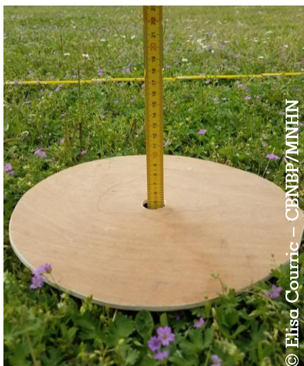
Figure 2 : Herbomètre permettant de mesurer de façon plus précise la hauteur de la végétation au sein des placettes de suivi du parc Georges Valbon
