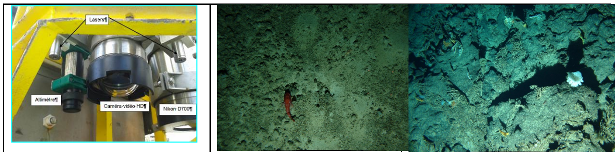
Photo 4 : Détails du système de caméra du SCAMPI et exemples d'images obtenues Copyright Ifremer
